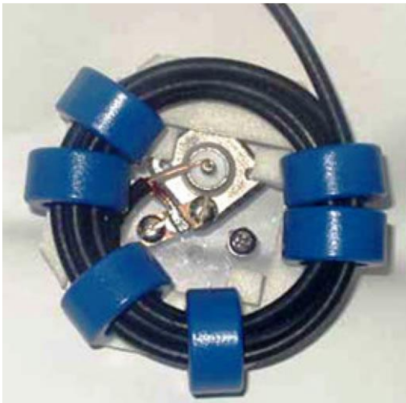
图 8 简单的共模扼流结构
