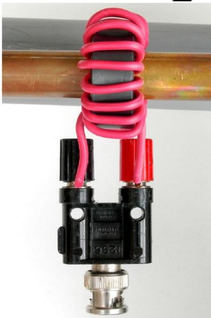
图 12 变压器耦合的概念和实际实现
