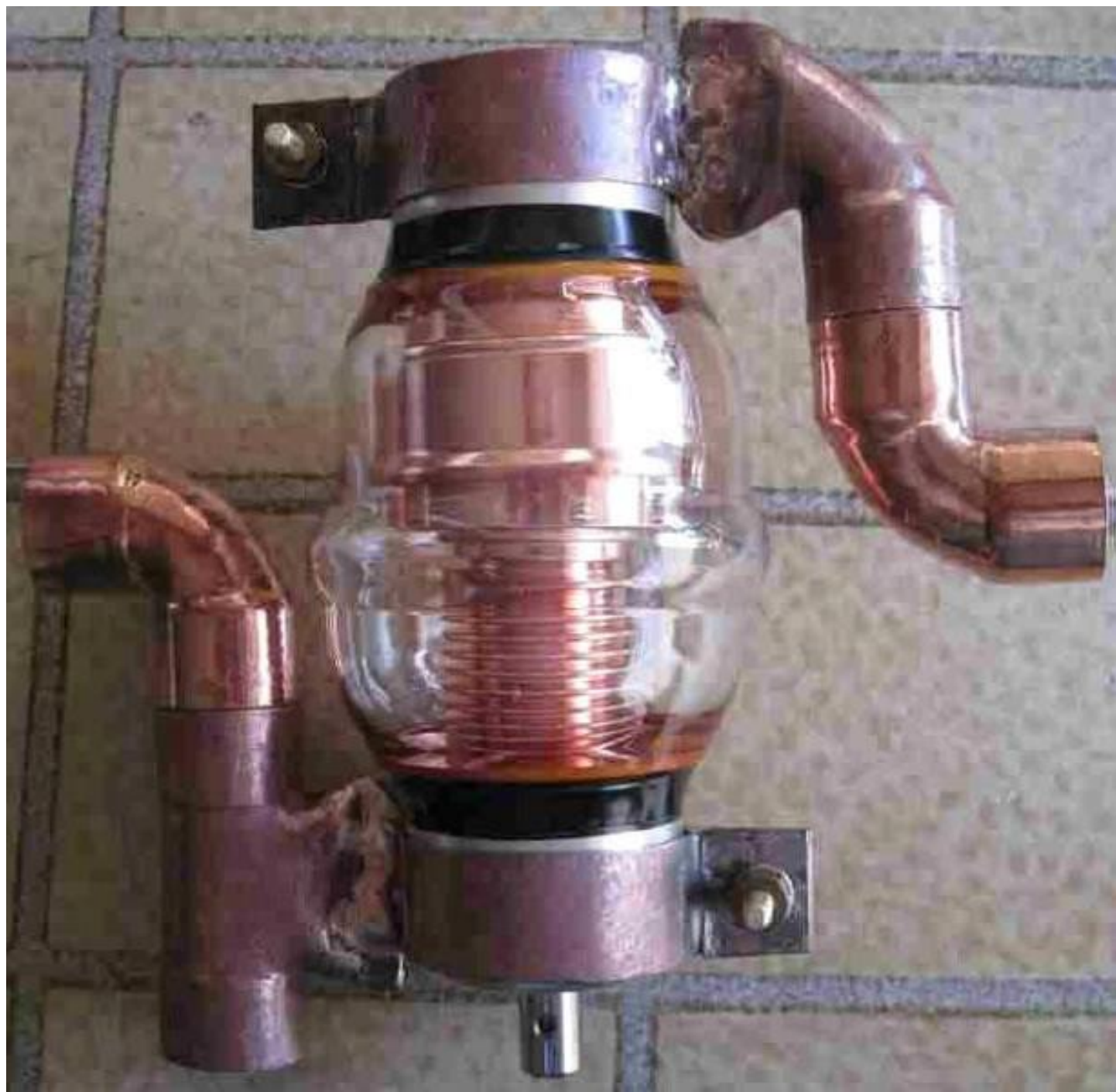
图 13 自制电容器夹具与焊银铜配件
