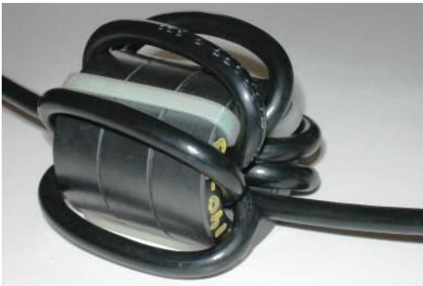
图 9 可替代的共模扼流结构
